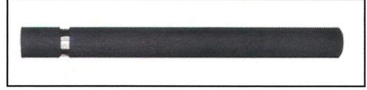
Il modello di dissuasore proposto è un elemento di design molto piacevole esteticamente per l'arredo urbano o come delimitatori per zone pedonali. La struttura è in acciaio con fascia sulla parte superiore in catarifrangente. La base ad incasso, amovibile attraverso l'utilizzo di una serratura. Il diametro è di 6 cm, mentre la sua altezza è di 100 cm.
